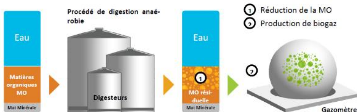
Figure 74 10: processus de production de biogaz par méthanisation
