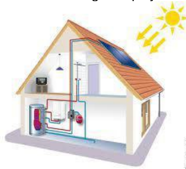
Figure 42 : schéma de principe de fonctionnement des capteurs solaires thermiques
