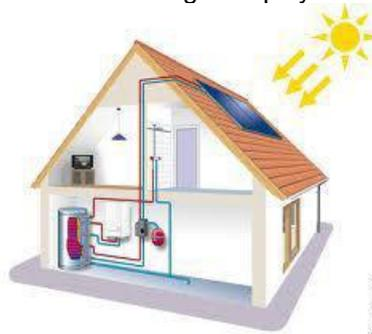
Figure 38: schéma de principe de fonctionnement des capteurs solaires thermiques
