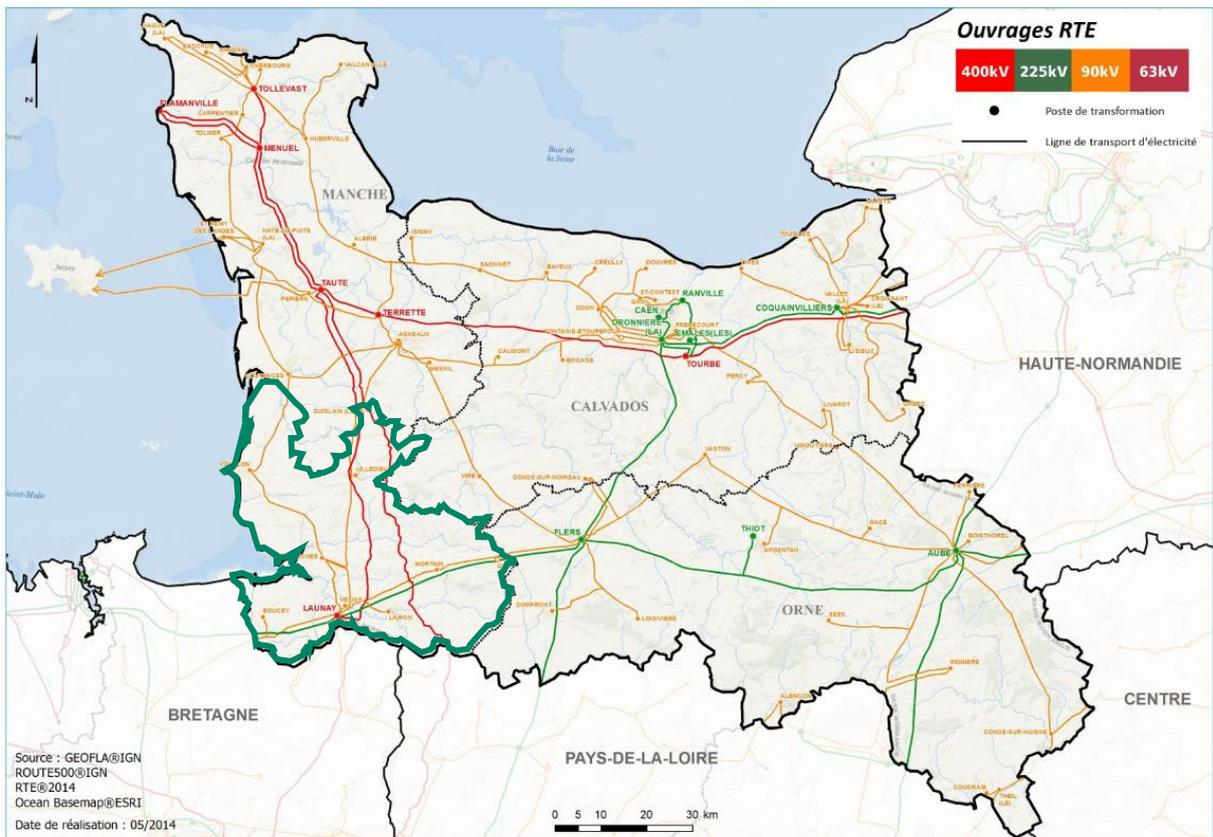
Figure 91: carte du réseau de transport d'électricité en Basse Normandie (source : RTE)
